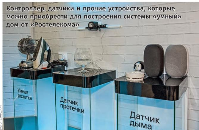
Контроллер, датчики и прочие устройства, которые можно приобрести для построения системы «умный» дом от «Ростелекома»
